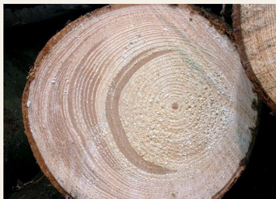
Foto čela kmene smrku, kde lze křemenitost snadno rozeznat v podobě tmavých zón.
