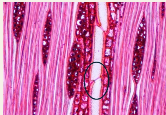
Řada vertikálně uspořádaných na sebe vzájemně perforacemi navazujících cévních článků. Tangenciální řez dřevem jasanu ztepilého, zvětšeno 100x.
