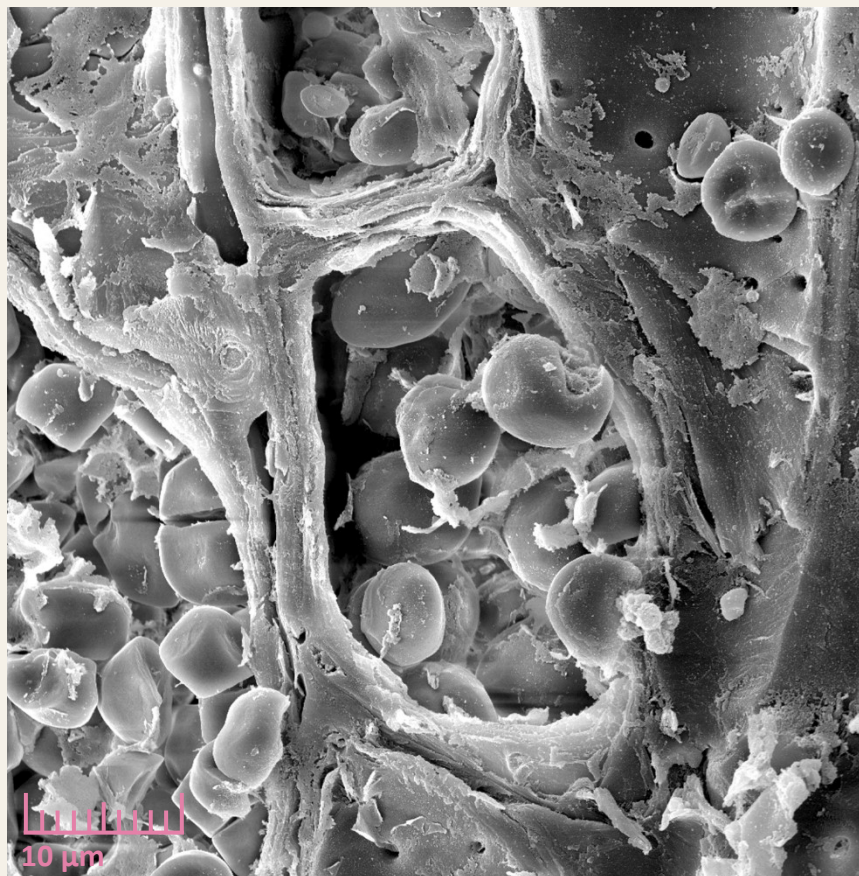
Řez dřevňovým paprskem vyplněným škrobovými kuličkami. Snímek z elektronového mikroskopu při zvětšení 5 000krát.
