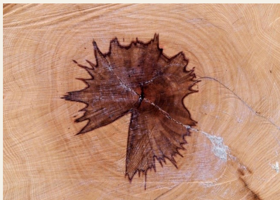
Na fotografii čela bukové kulatiny je zřetelně vidět paprscitě nepravé jádro způsobené houbovou infekcí.
