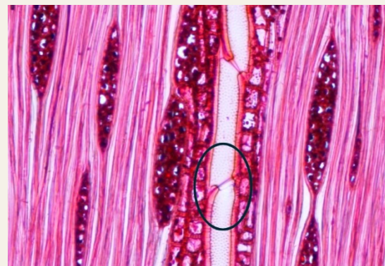
Řada vertikálně uspořádaných na sebe vzájemně perforací navazujících cévních článků. Tangenciální řez dřevem jasanu ztepilého, zvětšeno 100x.
